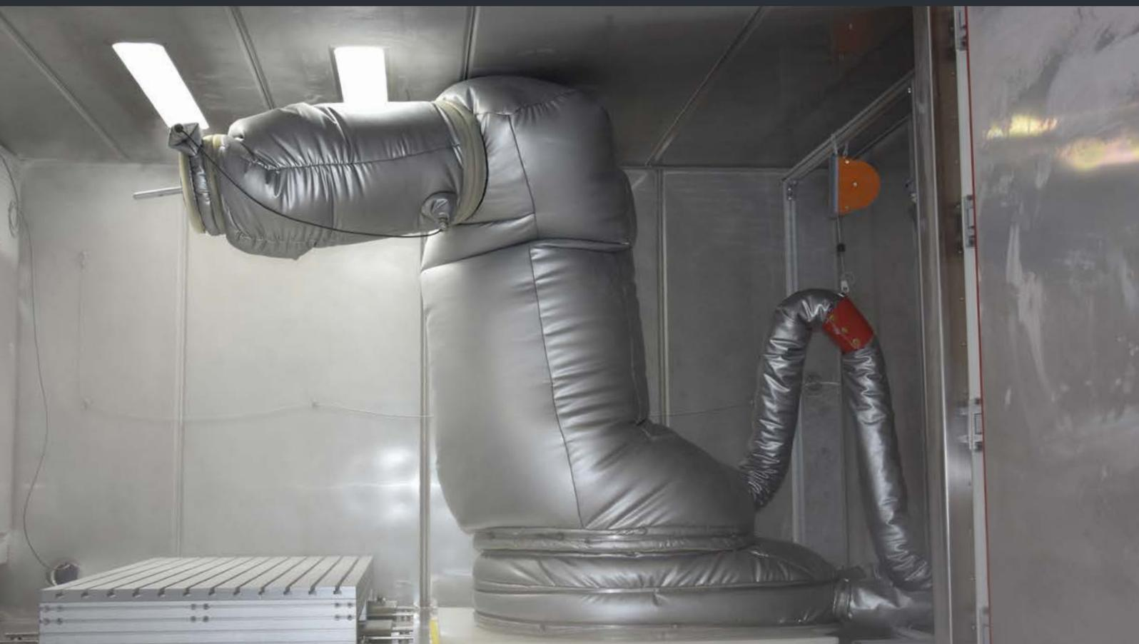
Protezione isolante multistrato per limitare lo scambio di calore
